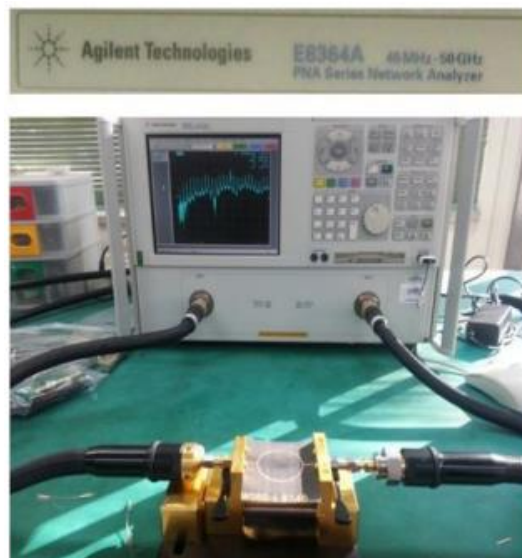
リング共振器試験にはAgilent E8364A PNA
